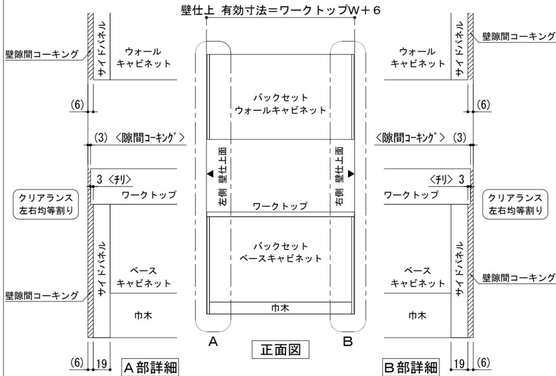
※ 本図は、バックセット単独・両側側面壁の場合を示す。
