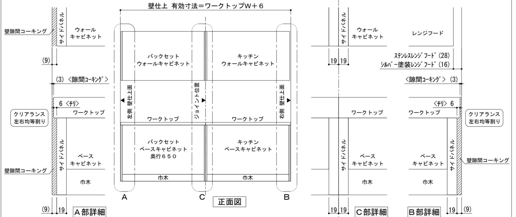
※ 本図は、左側バックセット+右側キッチン(左シンク)・両側側面壁の場合を示す。
