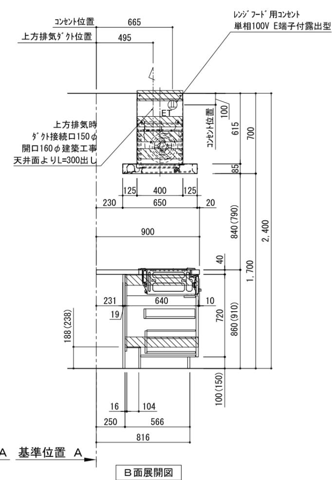
取付下地材 30X90 又はｺﾝﾊﾞｯﾄ12t (建築工事)
