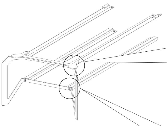
上部用フレームを下方からボルトで固定する(計8ヵ所)
