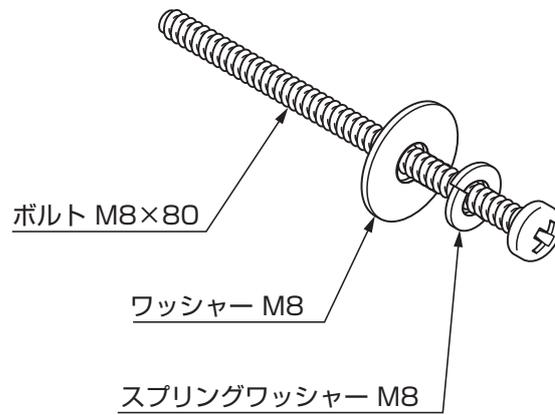
② ダイニング側のキャビネット上板の貫通穴から取付ボルトを差し込み仮締めしてください。
