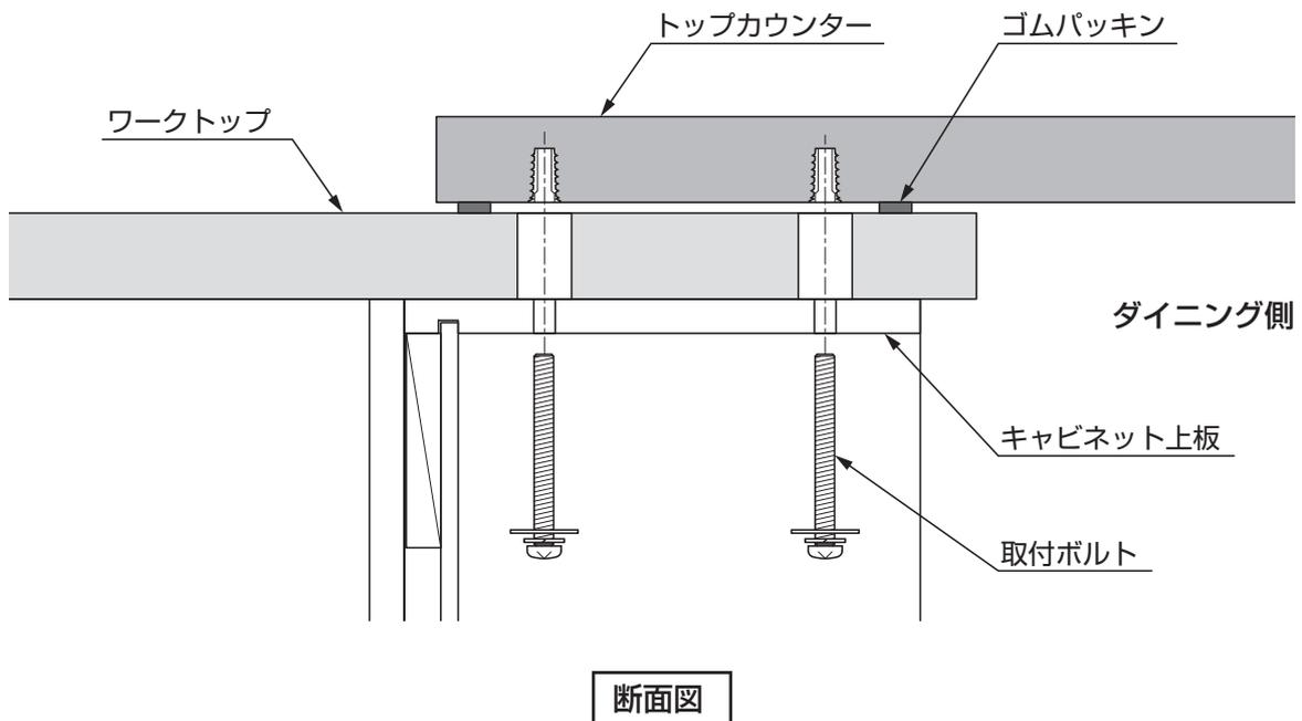
③ ワークトップ～トップカウンターの張り出し(チリ)寸法を再度調整して、取付ボルトを本締めしてください。
