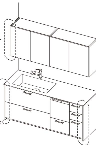
※ 4mmの隙間にはワークトップ固定後にふさぎプレートを取付け 👉 P.8参照
