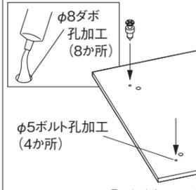
③ ダボ穴にパネル脚の木ダボを挿入する。その時、パネル脚の引寄金物に天板裏面の引寄ボルトの頭を挿入する。
