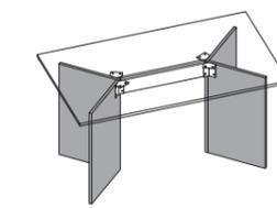
② パネル脚用部材AおよびBを組み合わせてパネル脚を組み立てる。
