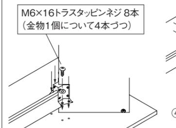
③ パネル脚を連結金物で固定する。パネル脚側面のガイド穴に合わせてネジ止めする。
