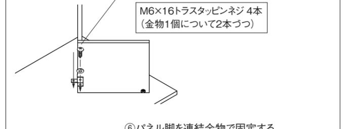
⑥ パネル脚を連結金物で固定する。天板裏面のガイド穴に合わせてネジ止めする。
