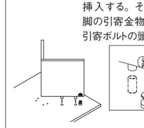
④ 引寄金物のネジを回して、天板とパネル脚を連結する。
