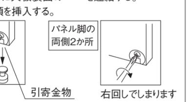
⑤ 天板とパネル脚を連結金物で固定する。天板裏面のガイド穴に合わせてネジ止めする。
