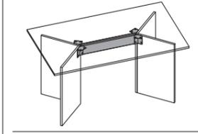
① 天板と補強材を連結金物で固定する。天板裏面のガイド穴に合わせてネジ止めする。
