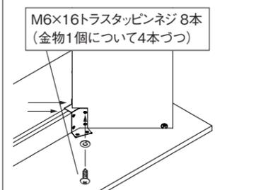
② 補強材を連結金物で固定する。補強材側面のガイド穴に合わせてネジ止めする。
