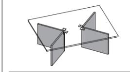
② パネル脚用部材AおよびBを組み合わせてパネル脚を組み立てる。
