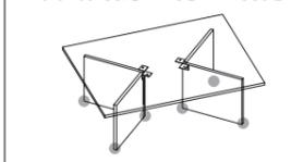
パネル脚接地面に床面傷防止材を貼り付ける。
