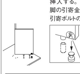
④ 引寄金物のネジを回して、天板とパネル脚を連結する。
