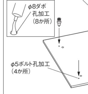
③ ダボ穴にパネル脚の木ダボを挿入する。その時、パネル脚の引寄金物に天板裏面の引寄ボルトの頭を挿入する。
