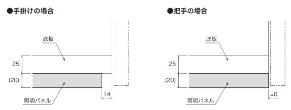
キャビネット内部から照明パネルを固定します。固定後、ネジ頭に化粧シールを取り付けてください。
